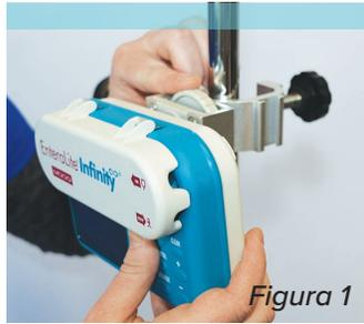
2. Fije la abrazadera a la bomba insertando el pequeño tornillo de la abrazadera en la abertura localizada en la parte posterior de la bomba Infinity. Gire la rueda gris para apretar el tornillo. Asegúrese de no apretarla demasiado, para no dañar la bomba.
