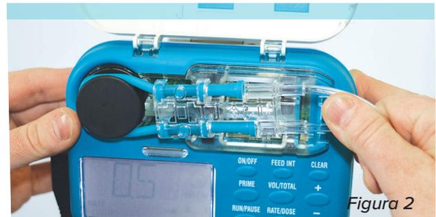
2. Encienda la bomba. Localice el botón ON/OFF (Encendido/Apagado) del lado derecho de la pantalla. Presiónelo y manténgalo oprimido por 1 o 2 segundos para encenderla.
